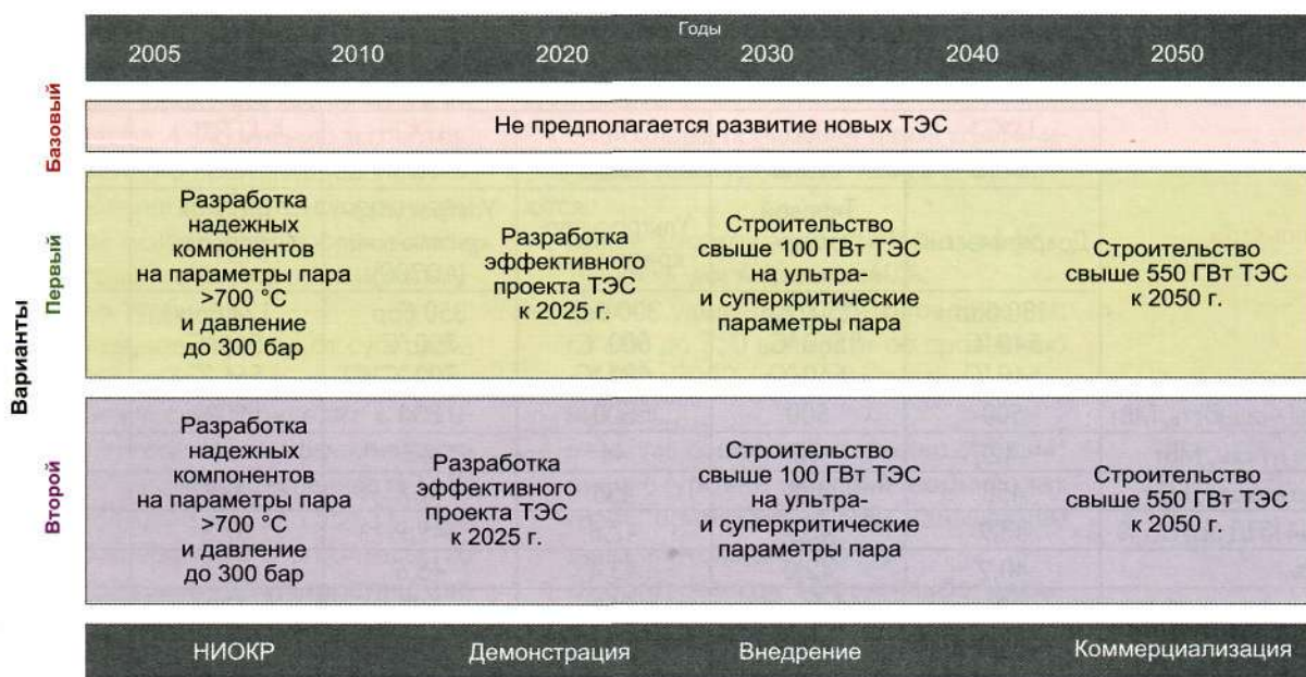
Рис. 5 [1]. Временная последовательность разработки технологий новых ТЭС на ультра- и сверхкритические параметры пара
