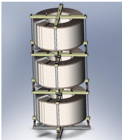
Рис. 1. 3-D модель реактора с вертикальным расположением фаз
