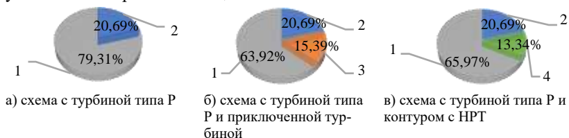
Рисунок 1 - Структура распределения теплоты для различных вариантов противоаварийных турбоустановок в конденсационном режиме работы (без отпуска теплоты потребителю) при температуре наружного воздуха 20 °С: 1 - потери в холодном источнике; 2 - электрическая мощность турбины типа Р; 3 - мощность нетто приключенной турбины; 4 - мощность нетто CO 2 турбины.
