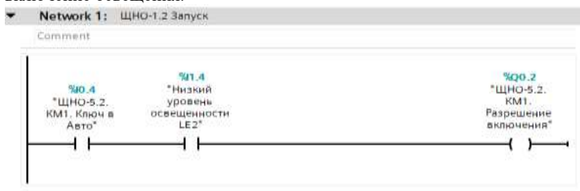
Рисунок 1 - Блок схема управления фасадным освещением с учетом датчика освещенности
