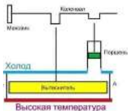
Рисунок 1 - Принципиальная схема демонстрационной модели двигателя Стирлинга
