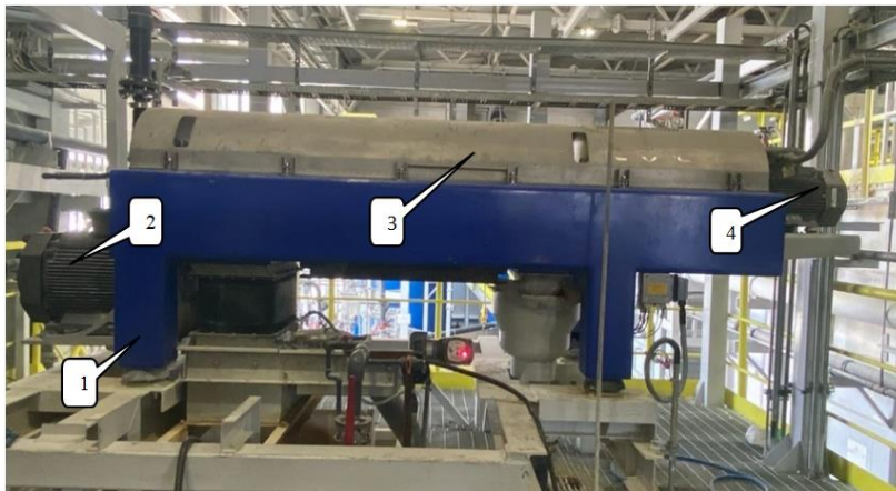
Рис. 1. Внешний вид центрифуги Alfa Laval:
