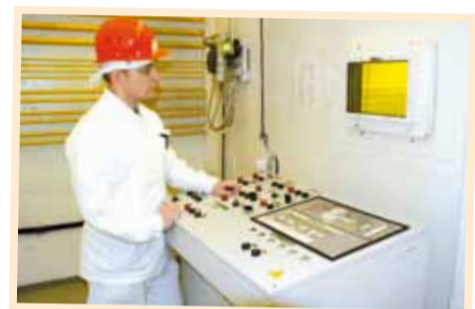
Пульт управления прессом ХТРО, обеспечивающий защиту персонала от радиационного воздействия
