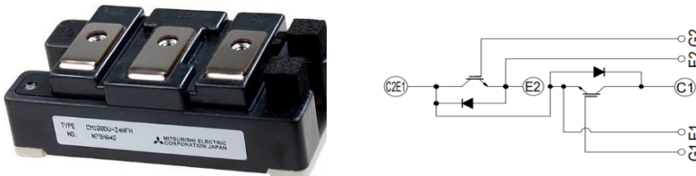
Рис.2. Внешний вид (а) и электрическая схема соединений (б) IGBT модуля Mitsubishi
