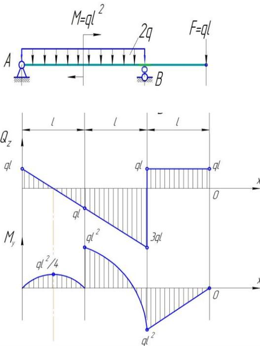
Из вида эюры  $Q_z$  следует, что в сечении  $A$  (на левой опоре) действует сосредоточенная сила – реакция  $R_A = ql$  и направленная вверх, а в сечении  $B$  (на правой опоре) реакция  $R_B = 4ql$  и направленная вверх. На пролете  $AB$  распределенная нагрузка  $q' = \frac{dQ_z}{dx} = 2q$ .
