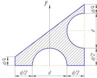
Для фигуры, изображенной на рисунке определить осевой момент инерции относительно оси  $y$  ( $J_y$ ), если  $d = 0,1$  м.
