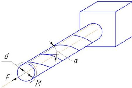
Нить наклеена на стержень круглого поперечного сечения по винтовой линии с углом  $\alpha$  между касательной к нити и осью стержня  $z$ .
