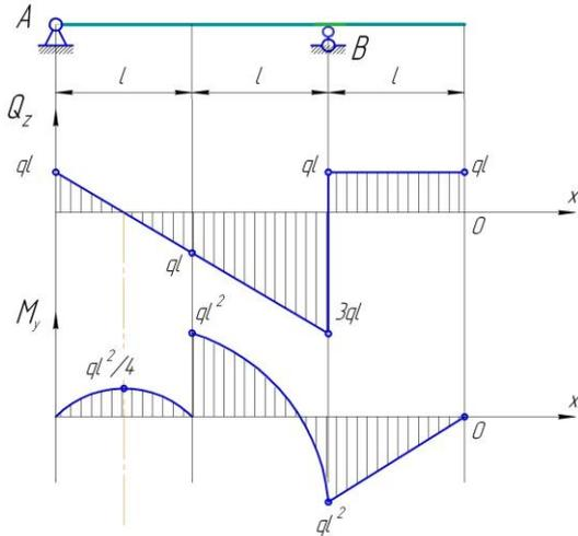
Для однопролетной балки по заданным эюграм  $Q_z$  и  $M_y$  восстановить нагрузку на балку и определить опорные реакции.
