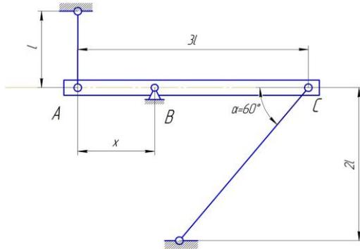
Где следует расположить опору  $B$ , чтобы в конструкции не возникали напряжения при изменении температуры окружающей среды? Материал стержней одинаковый. Брус  $AC$  абсолютно жесткий.
